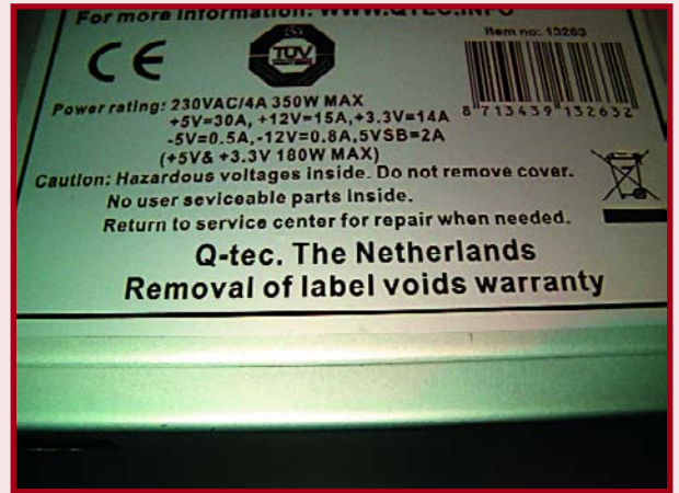
2. Satte 15 A an 12 V bedeuten 180 W für unsere Halogenbeleuchtung.
