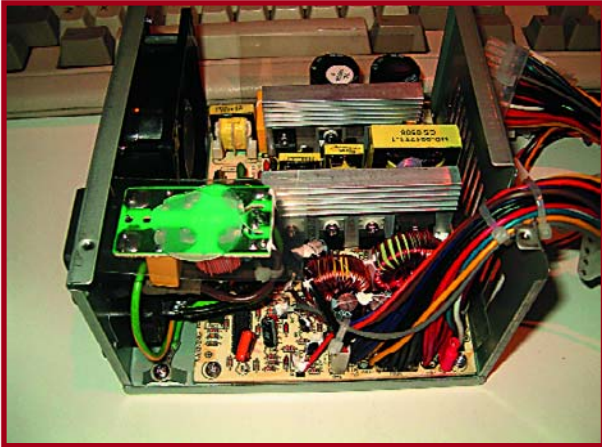
3. Die Stromversorgung – im jungfräulichen Zustand.
