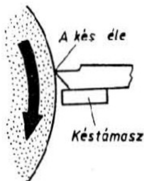
69. ábra. A korong helyes forgásiránya
