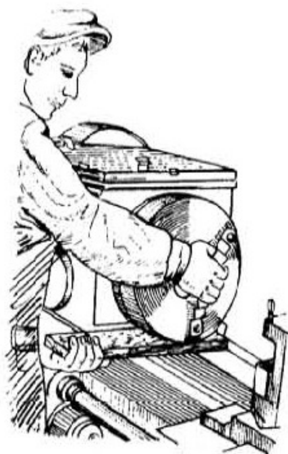
119. ábra. Nehéztokmány felszerelése a főorsóra
