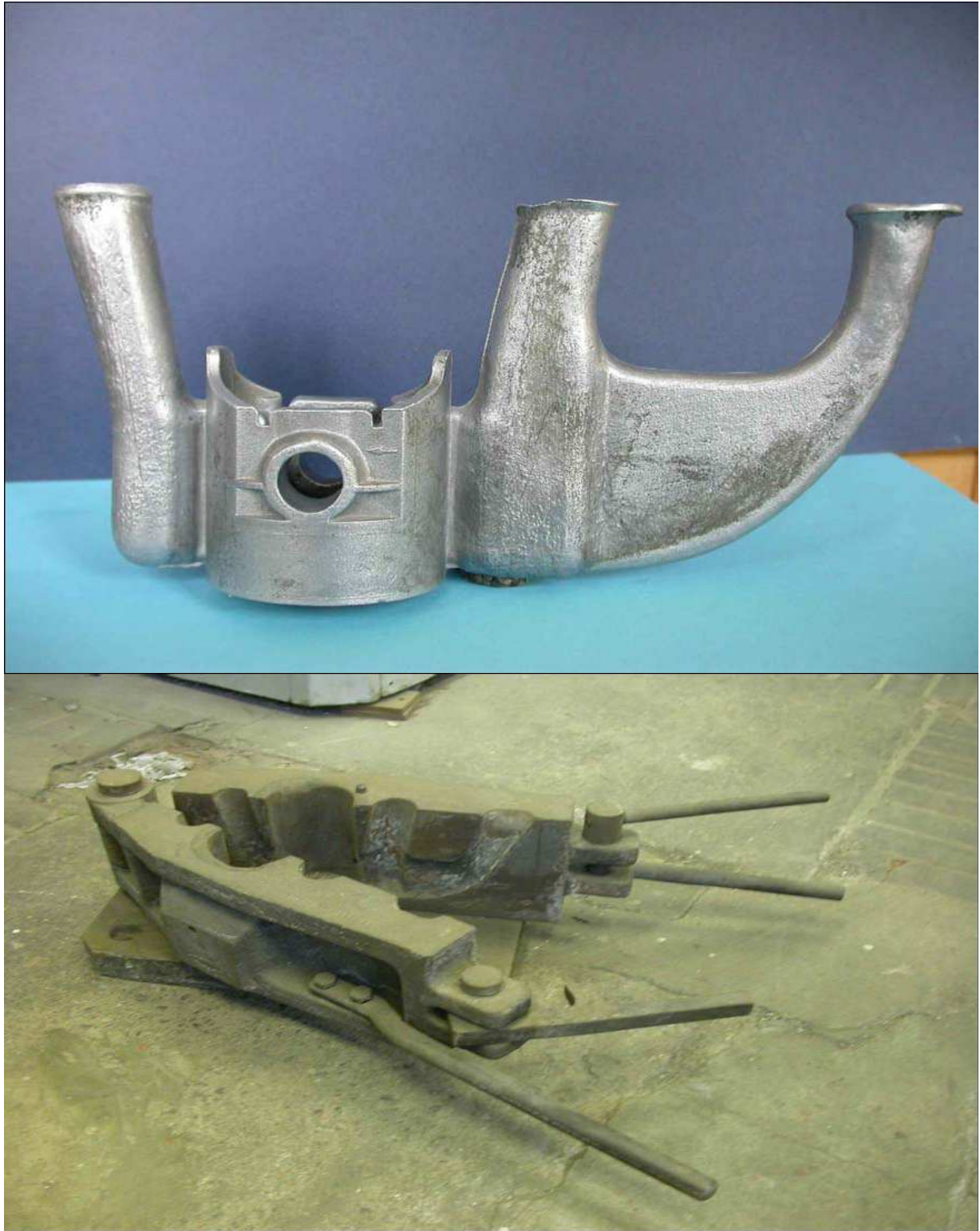
7. ábra – Dugattyú alkatrész felöntésekkel és gravitációs öntőkokillája
