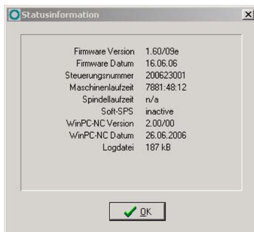
Anzeige der Steuerungsversion
