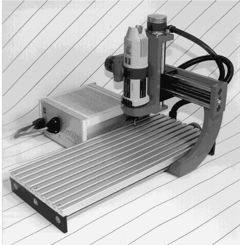
Beispiel einer 3-Achs-Fräsanlage
