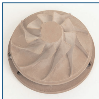
5-Achsen Bearbeitung / 5 axis machining
