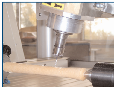
GFV-Anlage: 3+2 Achsen / GFV machine: 3+2 axis
