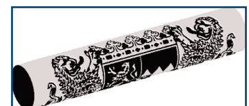
Komplexe Gravur mit "Ausspitzen" der Ecken, auf i-mes Maschine mit 4. Achse (Drehachse) / complex engraving with "Carving" of the corners, on i-mes machine with 4th axis (rotary axis)
