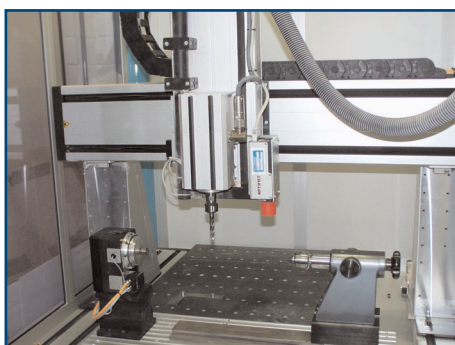
Integrierter Granittisch mit hoch präziser Dreheinheit / integrated granite table with high precision rotary unit
