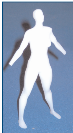
3D-Figur gefräst mit "Gieß-Spannverfahren" / 3D figure milled with mould clamping system
