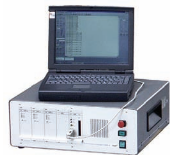
Controller C-142 mit Ansteuerung über Laptop
