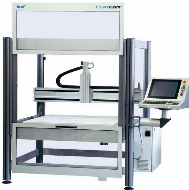
FLATCOM 40-H mit Untergestell, Schutzhaube und Maschinen-Bedienpult
