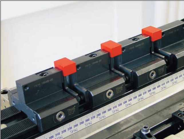
Dreiseitenbearbeitung ab 19mm Three-sided machining beginning at 19mm Usinage à trois côtés à départ de 19mm
