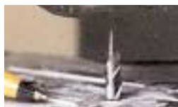
Größenvergleich zwischen einem Fräs-Werkzeug und einer Kugelschreiberspitze
