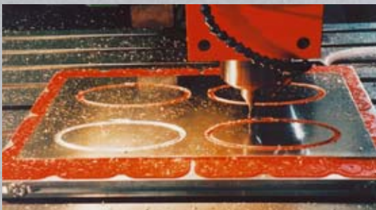
5-Seiten-Bearbeitung in einer Spannung und Durchfräsen ohne Sondervorrichtung mit VAC-MAT™
