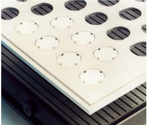
Vakuum-Schlitzplatte mit werkstückspezifischer Adaptermaske
