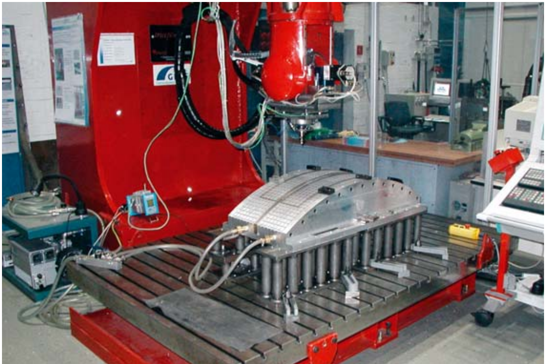
Unten: Sonder-3D-Vakuurrasterplatte für den Einsatz auf Reibrührschweißmaschinen
