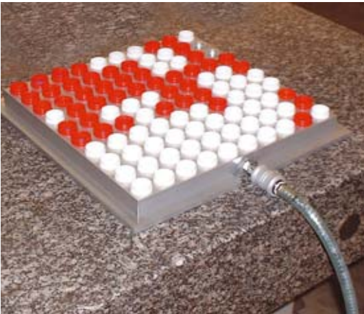
Vakuum- Spannplatte für Verschlusskappen Anwendung im QS-Bereich
