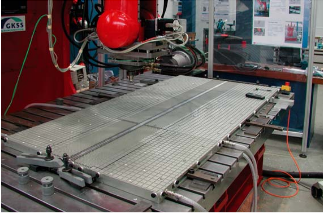
Oben: 2-teilige Vakuurrasterplatte für den Einsatz auf Reibrührschweißmaschinen
