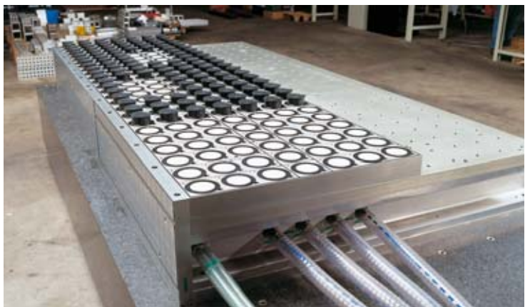
FLIP-POD™ Spannsystem zum Spannen eines großen Aluminiumteiles mit Durchbrüchen
