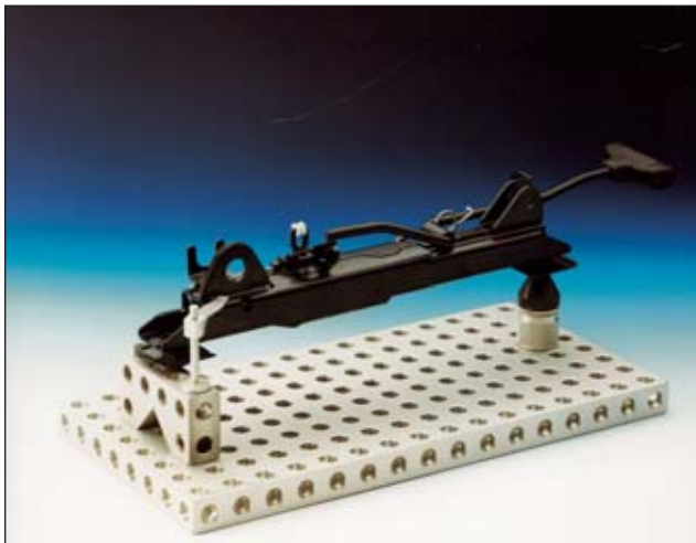
Sitzhalterung positioniert mit Zentrierspitze und Schraubbock zum Höhenausgleich
