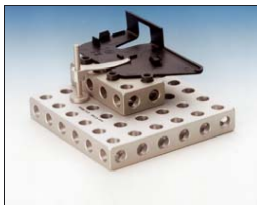
Kunststoffteil positioniert mit Absteckbuchsen und befestigt mit Nieder- halterfeder
