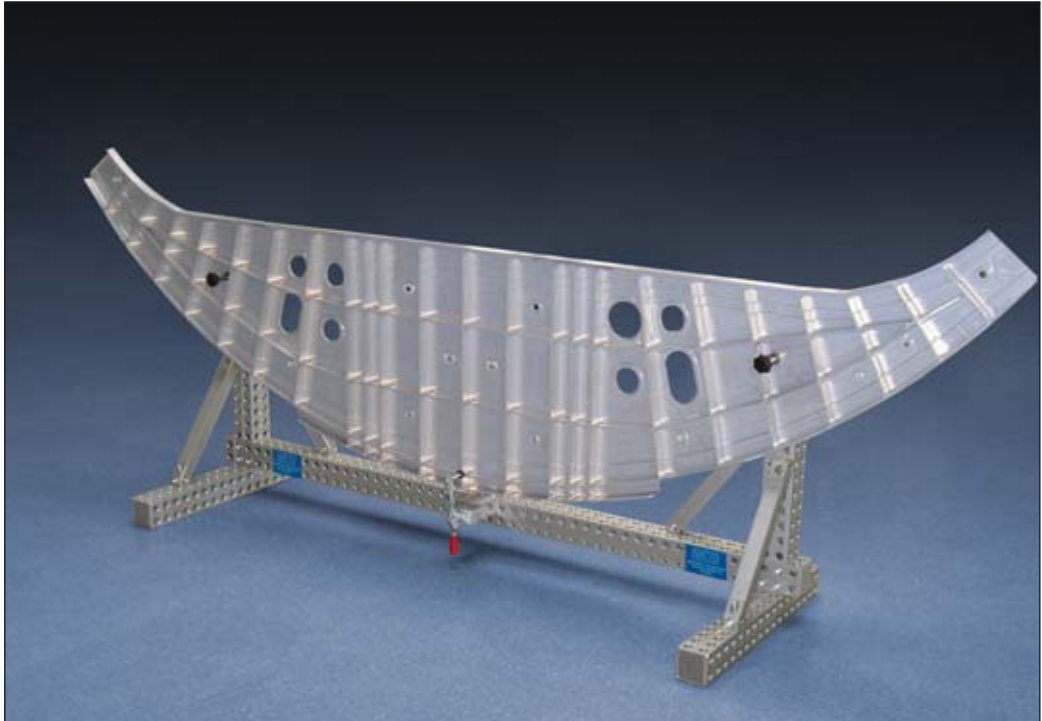
Alufix Classic Messaufnahme für einen Flugzeugspant
