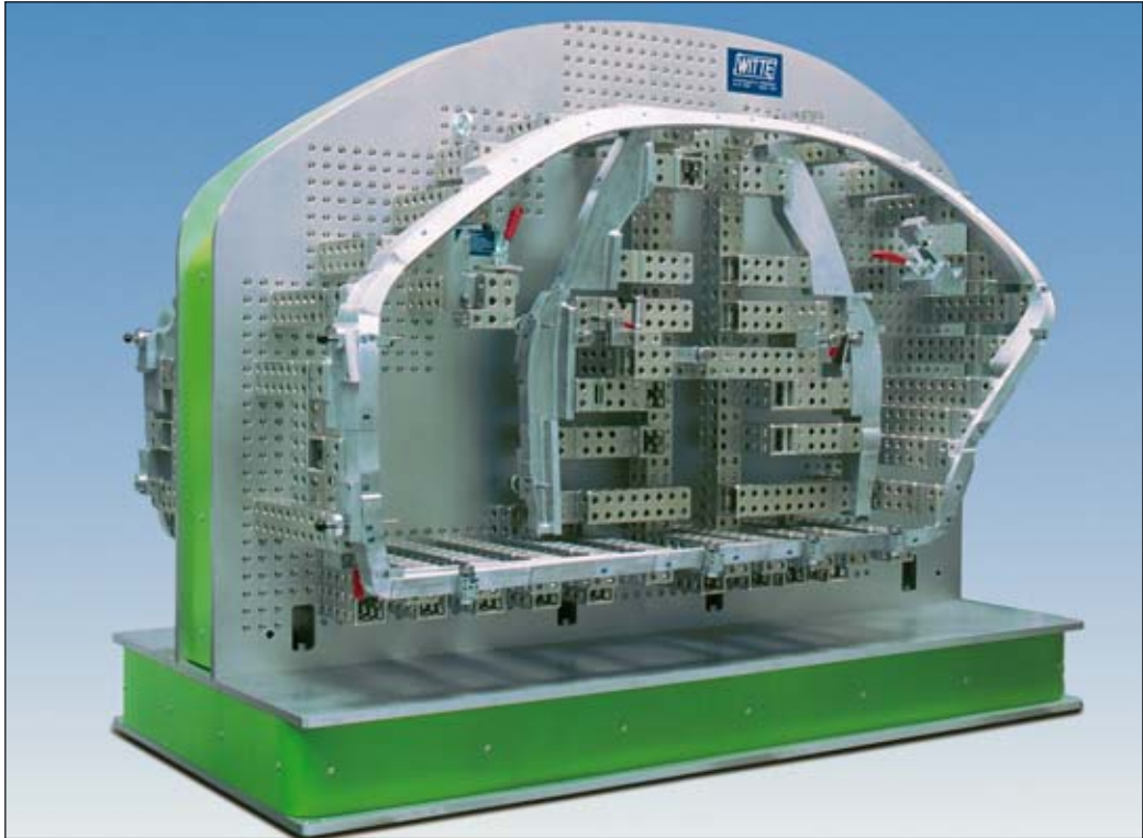
Kombinierte Kontrollvorrichtung für Türen, es können bis zu 4 Türen gleichzeitig geprüft werden
