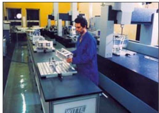
Rüsttischanlage für 3 KMM mit verfahrbarer Übergabebrücke
