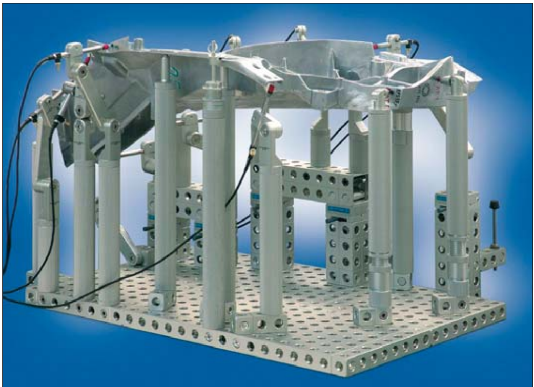
Messaufnahme aus Alufix Classic und Alugrip, mit elektronischen Messtastern
