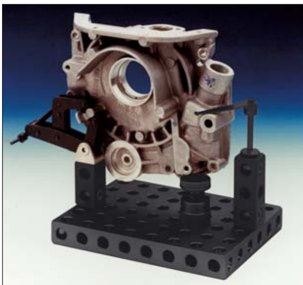
Wasserpumpengehäuse auf Schraubbock, befestigt mit Klemmzwinge und Niederhalterfeder
