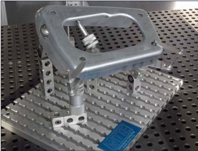
Mess- aufnahme aus Alufix Classic und Alugrip, mit abschwenkbaren Messuhren
