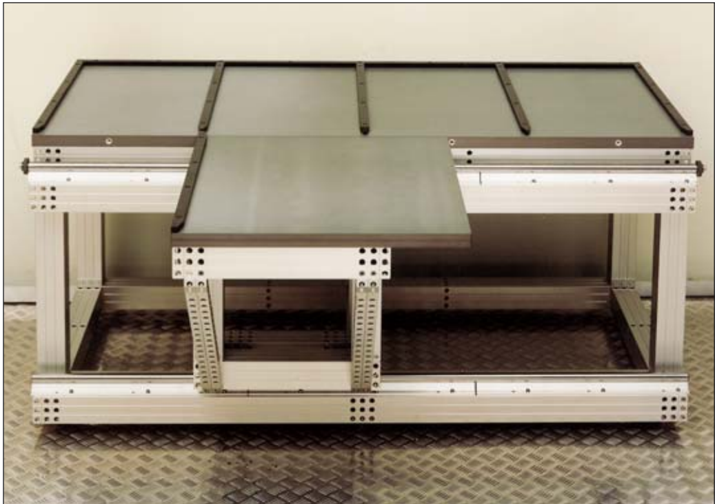
Rüsttisch mit 4 Parkplätzen für Luftlagerplatten, wird mit der Übergabebrücke an die KMM gestellt
