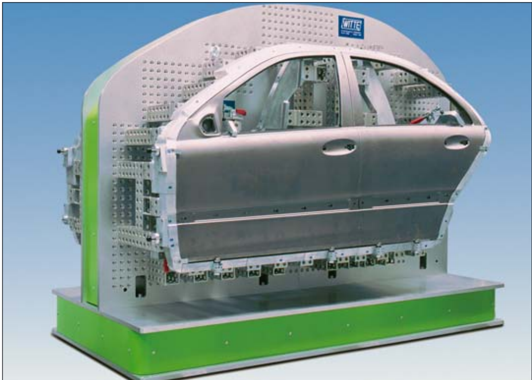
Kombinierte Kontrollvorrichtung für Türen, es können bis zu 4 Türen gleichzeitig geprüft werden
