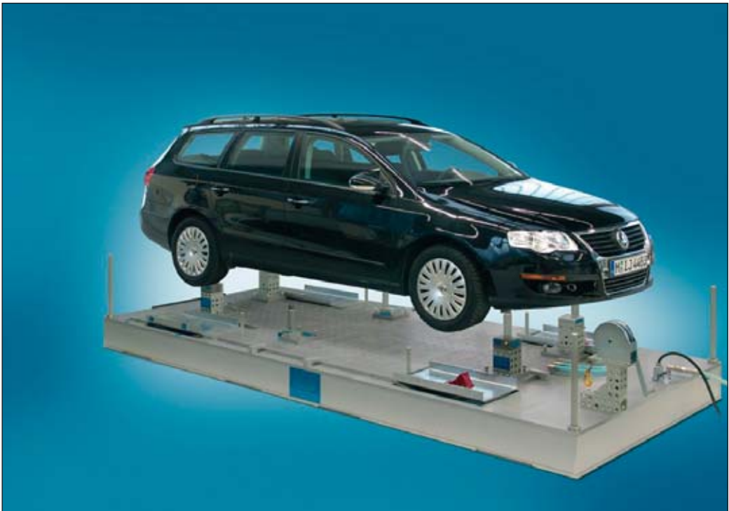
Messaufnahme Gesamtfahrzeug, bestehend aus luftgelagerter Sandwichplatte und teilespezifischen Alufix - Säulen
