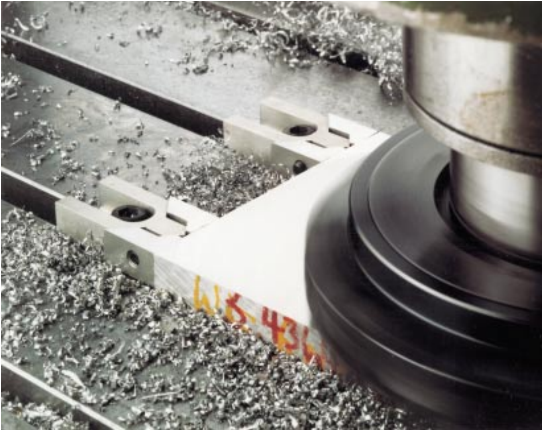
Niederzugspanner, das ideale Spannmittel zum Spannen von Platten für die Planfräsbearbeitung
