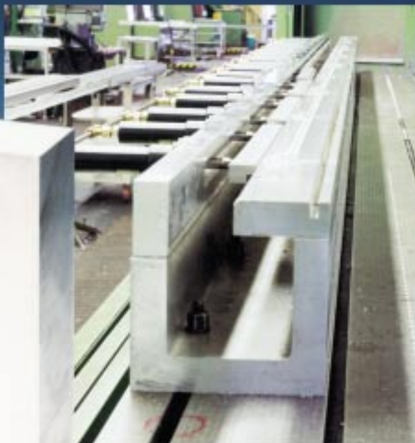
Spannvorrichtung, hydraulisch, 6000mm lang aus U-Profil 70102
