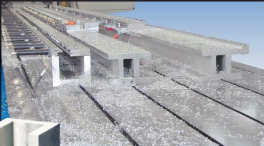
Spannvorrichtung, hydraulisch, 6000mm lang aus U-Profil 70102
