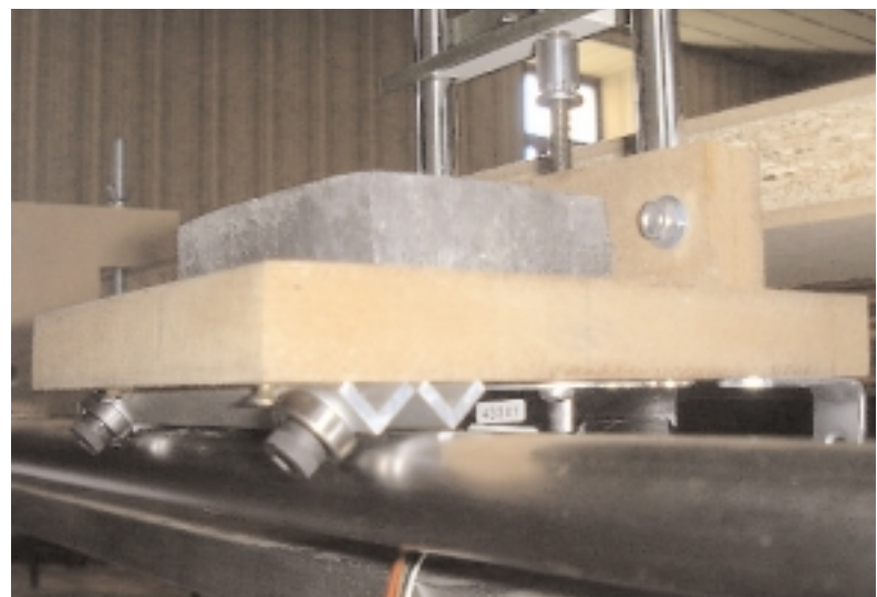
Le chariot des X vue de dessus. La pièce d'entraînement du chariot, en médium 10mm, est bien visible.
