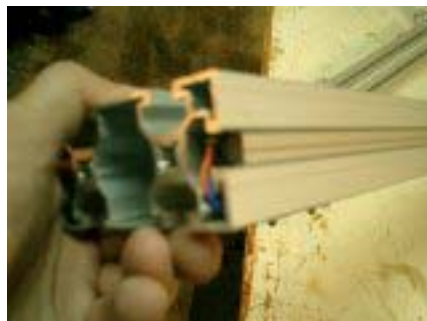
Microinterruptor de fin de carrera encajado en el perfil
