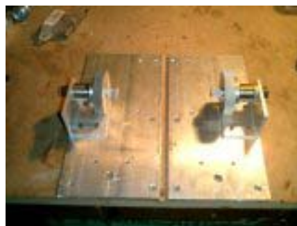
Poleas Y montadas en sus soportes
