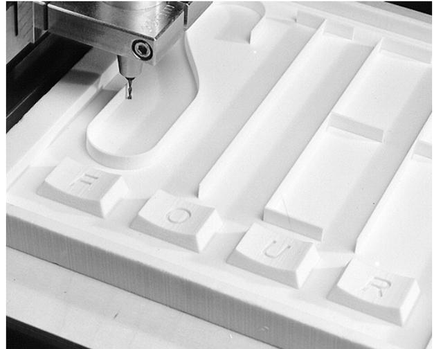
Bei Vorliegen einer Datei mit Höhenschichtlinien erlaubt die automatische Ebenenaufteilung eine einfache Herstellung von 3D-Körpern.
