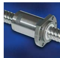
Baureihe 3526: Flanschnutter mit Gesamtumlenkung, zweigängig, Vorspannung mittels Teilungsversatz
