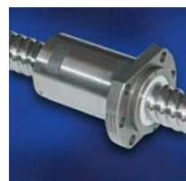
Baureihe 3426: Flanschmutter mit Gesamtumlenkung, zweigängig, Vorspannung mittels Kugelübermaß
