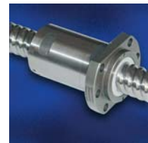
Baureihe 3526: Flanschmutter mit Gesamtumlenkung, zweigängig, Vorspannung mittels Teilungsversatz
