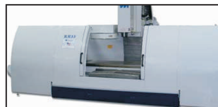
RH33 opcionális teljes borítással és forgácskihordóval
