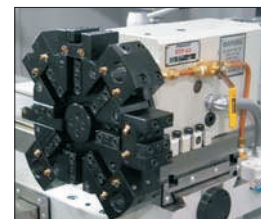
Opcionális automata revolver 16 mm az ML14 esztergán 16 vagy 19 mm az ML15 esztergán
