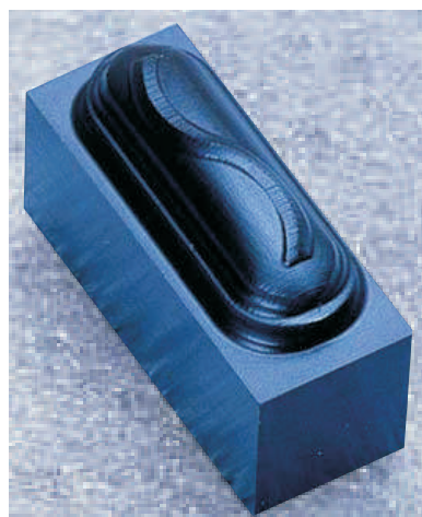
Munkadarab hagyományos CNC vezérléssel megmunkálva, visszacsatolási hiba korrekció nélkül.
