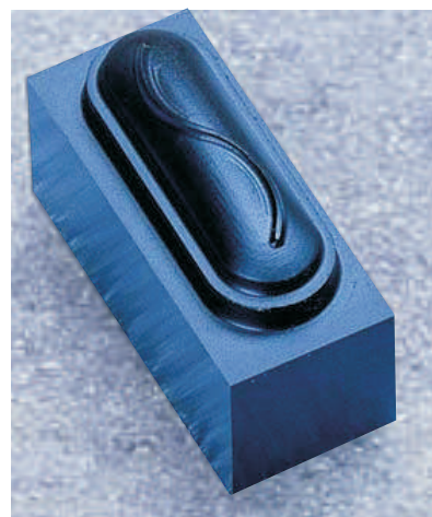
Munkadarab Centurion CNC vezérléssel és visszacsatolási hiba korrekcióval megmunkálva.
