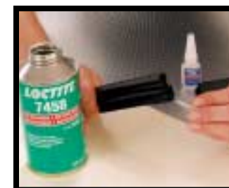
Loctite 7458 Kikeményíti a felesleges ragasztót. Csökkenti a kivirágzást és optimalizálja a ragasztás erősségét. Szagtalan. Olyan helyre javasolt a használata, ahol gyors kikeményedésre van szükség és ahol az esztétikai megjelenés is szempont azon kívül, hogy biztosítja a megfelelő és tömör ragasztási vonalat.
