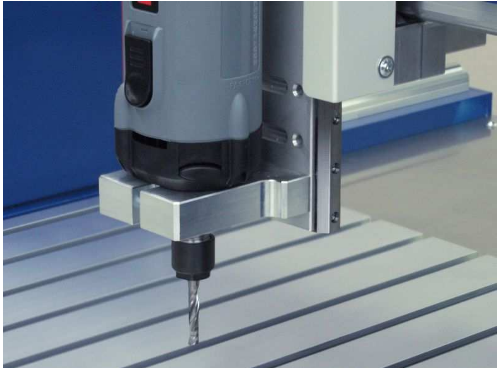
Detailansicht der Z-Führung und der höhenverstellbaren Fräsmotoraufnahme
