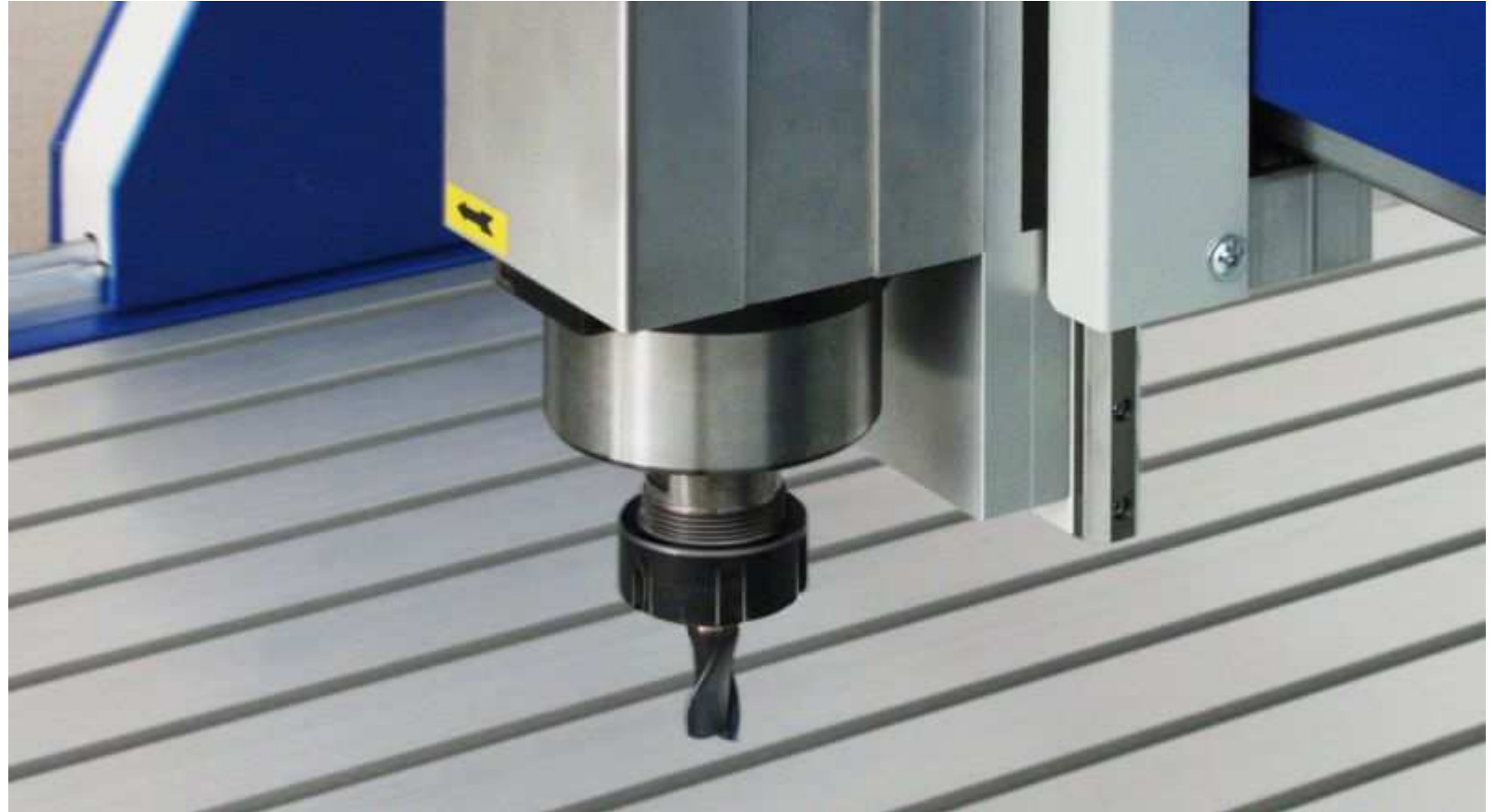
3,5kW Spindel auf der AL 1065 profi
