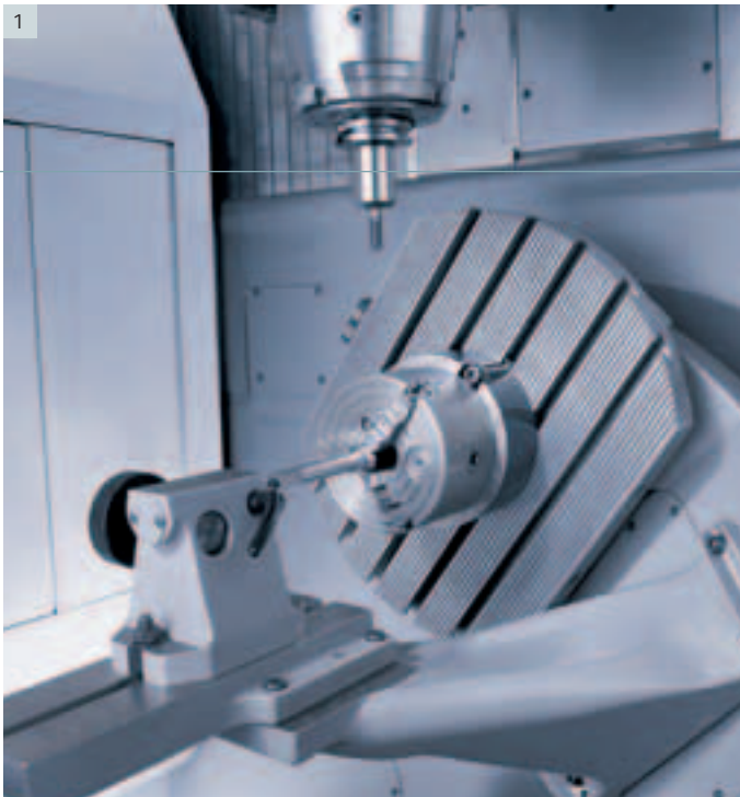
1|1 Gegenhalter für die präzise Bearbeitung lang dimensionierter Werkstücke |2-5| Der enorme Schwenkbereich des NC-Schwenkrundtisches lässt keine Wünsche in der Komplettbearbeitung offen
