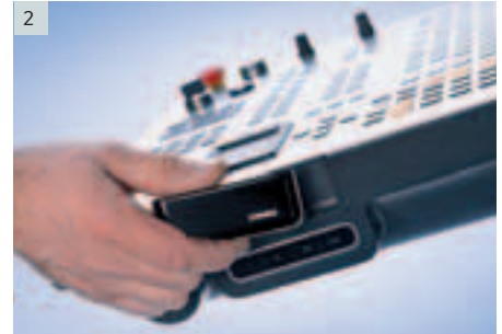
1|1 DMG ERGOline® Control mit DMG SOFTkeys® – frei belegbare Direkttasten für häufig anzuwählende Bildschirminhalte oder Bediensequenzen |2| DMG SMARTkey® – die elektronische Zugangskontrolle zur personalisierten Autorisierung des Bedieners mit entsprechenden Zugriffsrechten auf die Steuerung und die Maschine.
