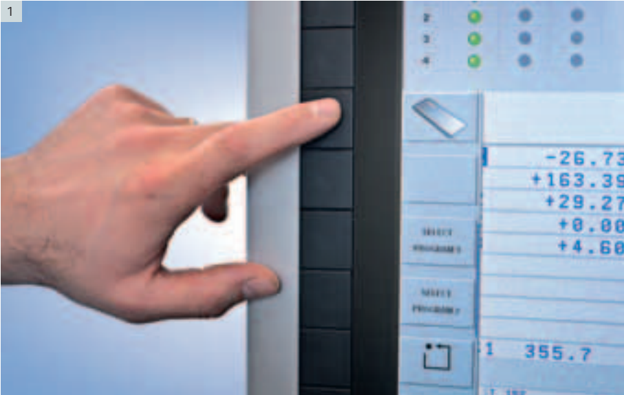
1|1 DMG ERGOline® Control mit DMG SOFTkeys® – frei belegbare Direkttasten für häufig anzuwählende Bildschirminhalte oder Bediensequenzen |2| DMG SMARTkey® – die elektronische Zugangskontrolle zur personalisierten Autorisierung des Bedieners mit entsprechenden Zugriffsrechten auf die Steuerung und die Maschine.
