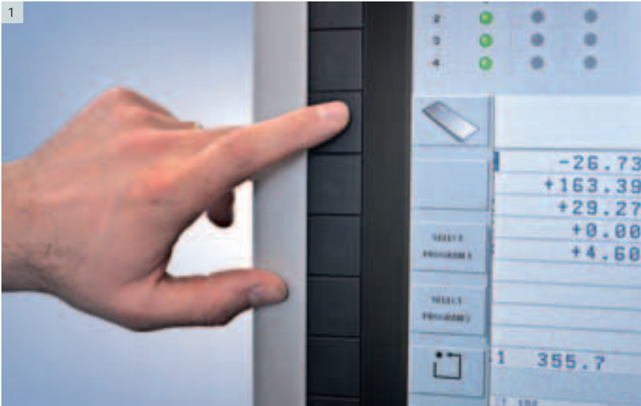
1| DMG ERGOline® Control mit DMG SOFTkeys® – frei belegbare Direktasten für häufig anzuwählende Bildschirminhalte oder Bediensequenzen |2| DMG SMARTkey® – die elektronische Zugangskontrolle zur personalisierten Autorisierung des Bedieners mit entsprechenden Zugriffsrechten auf die Steuerung und die Maschine
