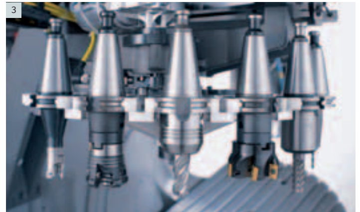
1|2| Werkzeugwechslerkette mit 30 Plätzen und schnellem Doppelgreifer 1|3| Werkzeugwechsler mit 16 Plätzen im Pick-up-Magazin
