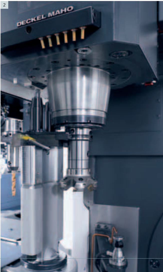
1|2| Werkzeugwechslerkette mit 30 Plätzen und schnellem Doppelgreifer 1|3| Werkzeugwechsler mit 16 Plätzen im Pick-up-Magazin
