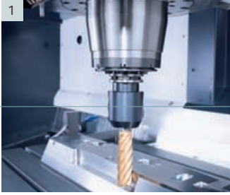
1| Leistungsstarke 10.000er-Motorspindel 2| 20er-Werkzeugmagazin 3| DMG ERGOline® Control mit 19"-Bildschirm 4| Großer Arbeitsraum für Werkstücke bis 1.000 kg (DMC 1035 V) 5| Schneller Doppelgreifer
