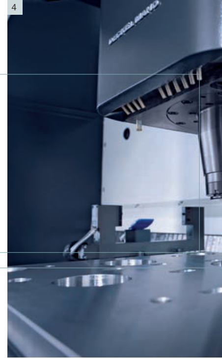
1| Leistungsstarke 10.000er-Motorspindel 2| 20er-Werkzeugmagazin 3| DMG ERGOline® Control mit 19"-Bildschirm 4| Großer Arbeitsraum für Werkstücke bis 1.000 kg (DMC 1035 V) 5| Schneller Doppelgreifer
