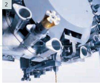
1| Leistungsstarke 10.000er-Motorspindel 2| 20er-Werkzeugmagazin 3| DMG ERGOline® Control mit 19"-Bildschirm 4| Großer Arbeitsraum für Werkstücke bis 1.000 kg (DMC 1035 V) 5| Schneller Doppelgreifer
