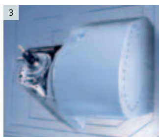
1| Kettenmagazin mit 40 oder 60 Magazinplätzen, auf Wunsch erweiterbar bis 180 Magazinplätze 2| Bearbeitung mit B-Achse 3| Schwenk-Fräskopf mit A-Achse für negative Winkel 4| Regalmagazin für Werkzeuge bis 650 mm Länge und 30 kg Gewicht (DMU 160 P)
