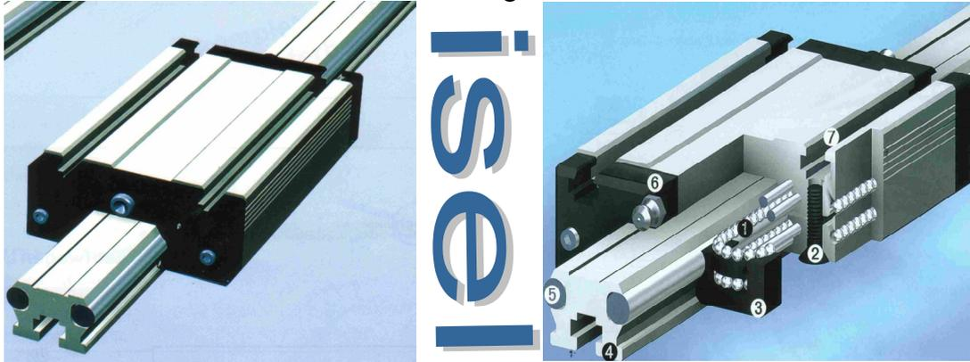
Der Antrieb der X-Achse wurde als Tandemantrieb realisiert. Jeder der beiden Wellenschlitten wird über eine M8-Gewindestange angetrieben. Die Gewindestange ist auf beiden Seiten gelagert. Die Lager sind jeweils in einem Alu-Lager-Block eingebaut. Die Lagerblockpläne sowie den Gewidemutterblockplan finden sie im [Anhang auf Seite 78 & 79](#). Bei einer Seite ist
