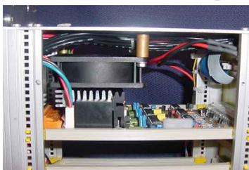
durch einen Lüfter gekühlt. Die Ein-Ausschalt-Hysterese wird durch den nachgeschalteten TTL- Schmitttrigger 74LS14 erreicht. Eine zu hohe Temperatur ist allerdings nicht die einzige Möglichkeit, die SM-Brücke abzuschalten. Mit dem Busy-Signal, welches mit dem Temperaturüberlastschutzsignal verodert ist, ist es möglich, z.B. über einen MC die SM-Brücke ein bzw. auszuschalten.
