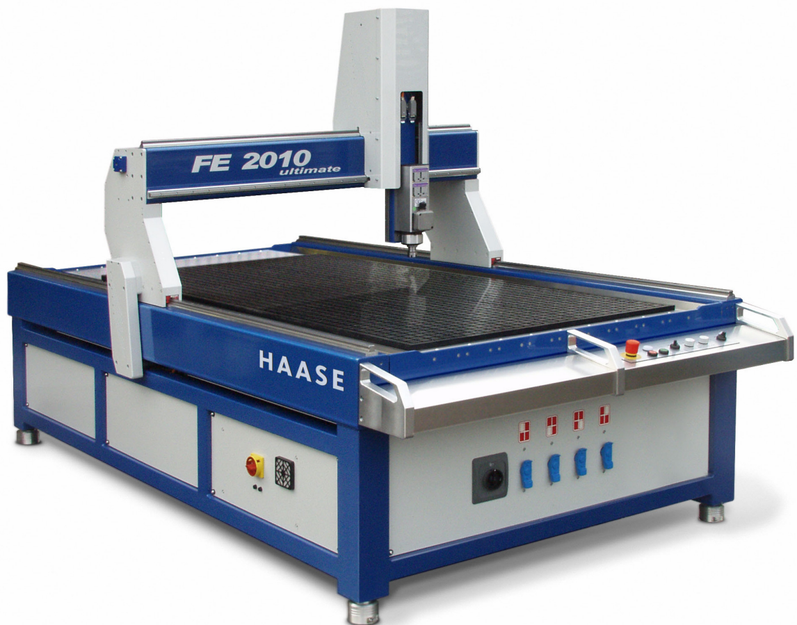
FE2010: Verfahrweg 2000 x 1000 x 300mm mit Linearführungen und Servomotoren auf ALLEN Achsen sowie 3,5kW Drehstromspindel mit 24.000 rpm und Vakuumtisch
