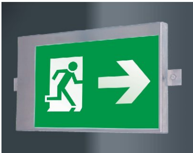
Sicherheitsleuchte für zentrale Notstromversorgung, Gehäuse: V2A Edelstahl / Sekurit Sicherheitsglas 150/280V AC/DC mit 10 m Zuleitung, Erkennungsweite 30 m Schutzart IP 67, Schutzklasse 1
