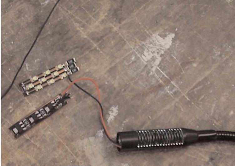
Einbau der beiden Platinen in das Lampengehäuse
