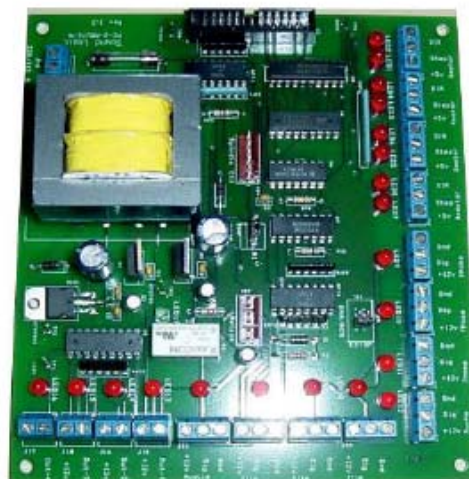
4.2. ábra 2 példa az általánosan alkalmazott galvanikusan leválasztó kártyára
