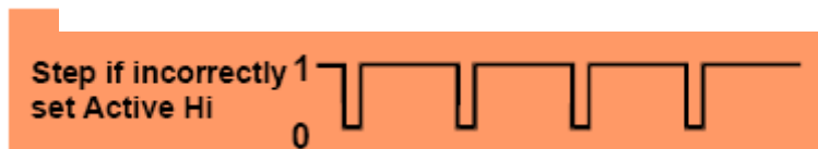
4.5. ábra Rosszul konfigurált kimenet megváltozott Step hullámformája
