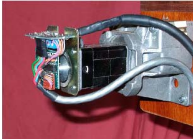
4.3. ábra Kis méretű szervo motor encoderrel (balra) és fogaskerék hajtóművel
