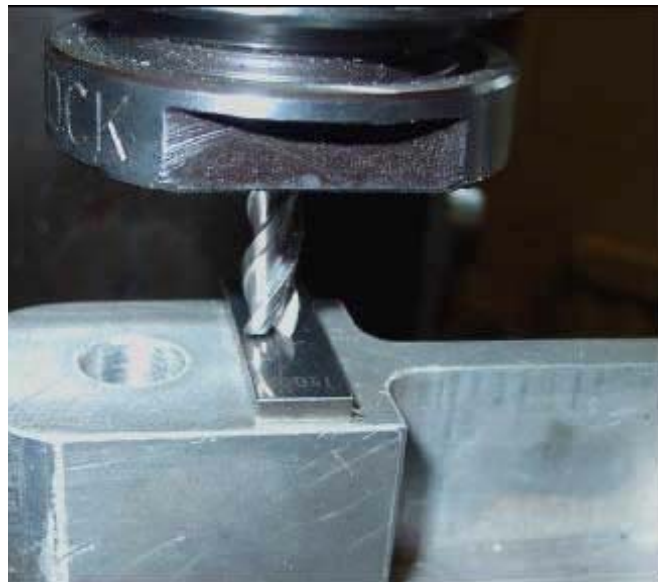
7.10. Ábra. Z eltolás meghatározása mérőhasáb érintésével marógépen
