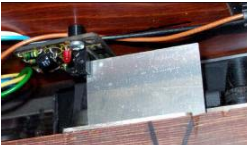
4.8. ábra - Asztalra szerelt szárnyas optikai kapcsoló hibásan szerelve a gépre
