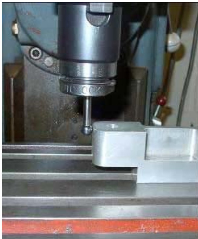
7.11. Ábra. Kontúr bemérés használata marógépen
