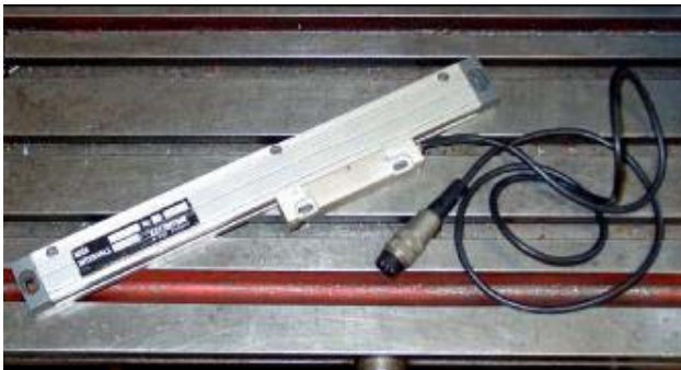
4.16. Ábra. Üvegskálás enkóder (beépítés előtt)
