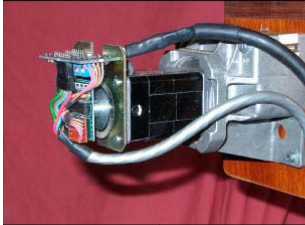
4.3. Ábra Kisméretű DC szervó motor enkóderrel (balra) és csigahajtóművel
