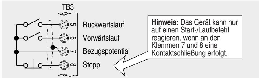
**P46 Einstellung 2 - Steuerung über das Program Keypad-Modul oder das Kommunikationsmodul**
