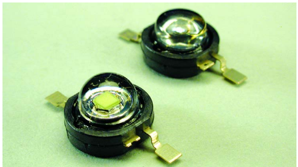
Bild 2. 1-W-LEDs von Luxeon in verschiedenen Bauformen.
