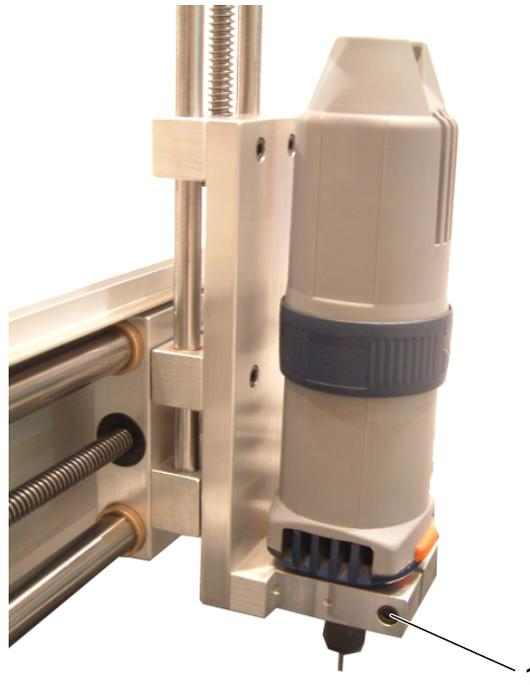
Abb. 12: Werkzeugaufnahme am Z-Schlitten
