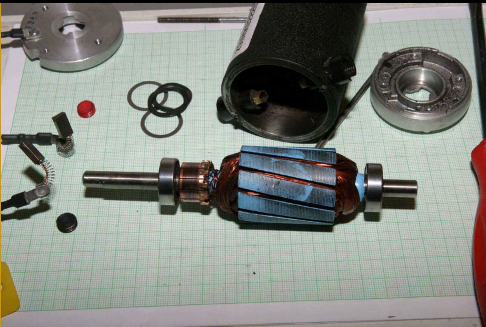
Kiegyensúlyozott forgórész (gondolom a pöttyről...)
