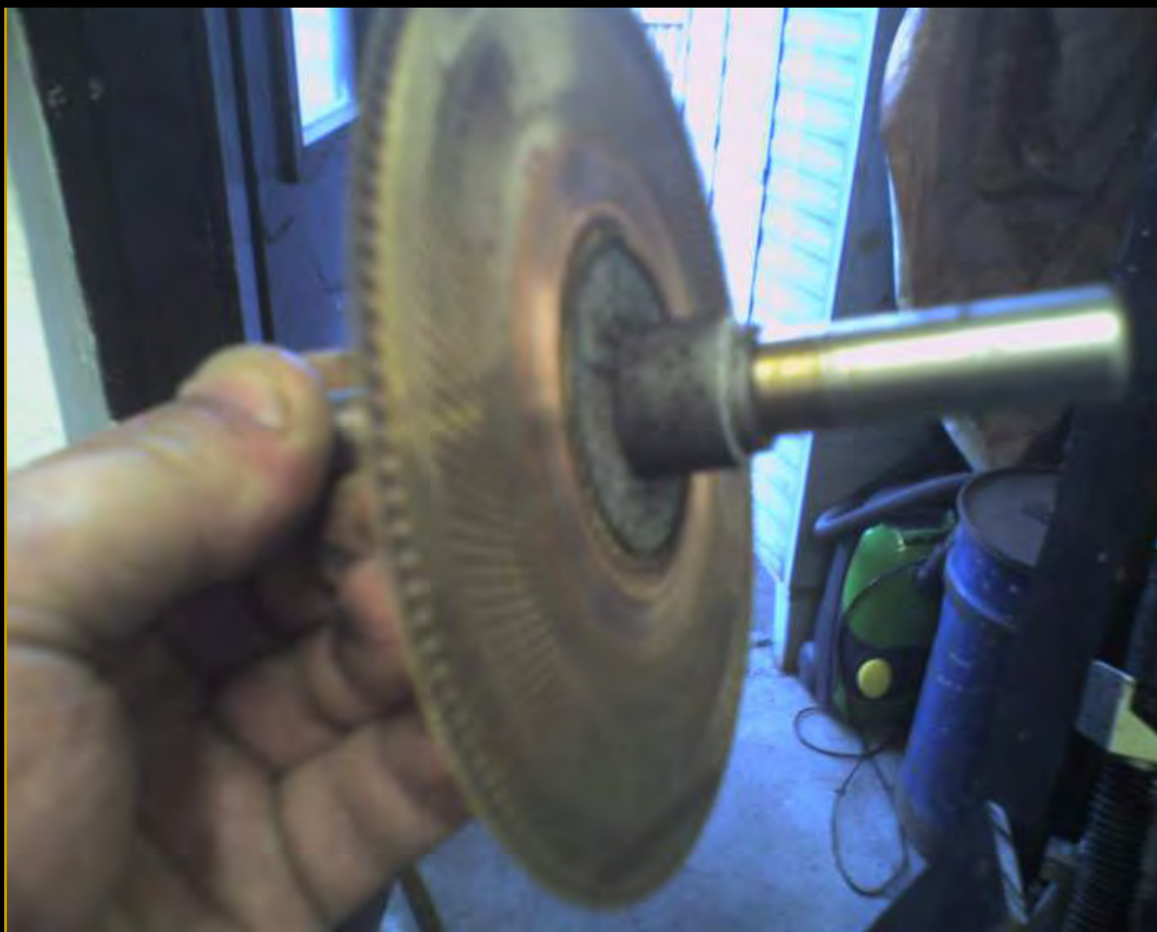
a tekercselés, egy üvegszálás tárcsára hajtogatott lemezkék
