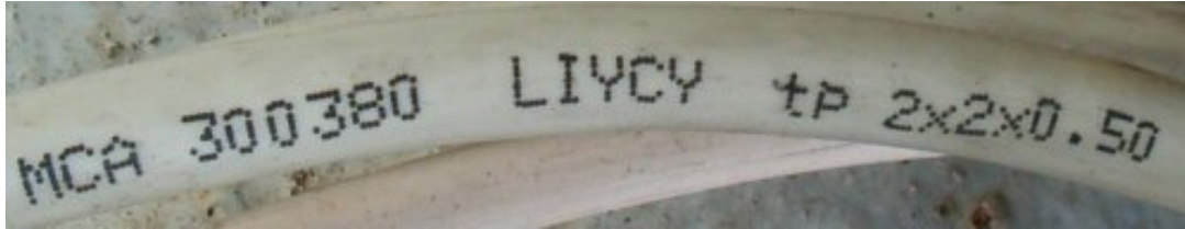
( 2 \times 2 sodrot érpár, 0.5\text{mm}^2 -es keresztmetszettel)
