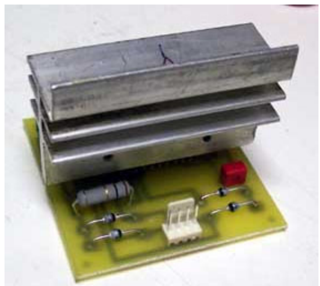
vhodný chladič GES –CH 03/70- rozříznutý napůl
