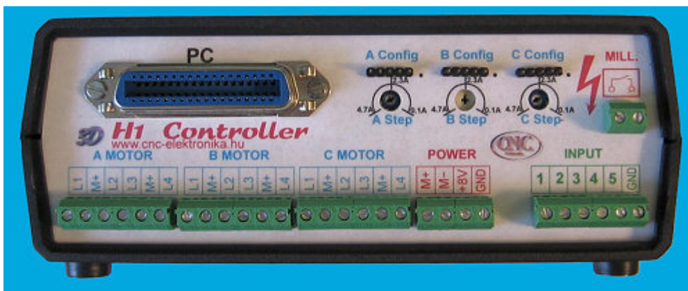
(dobozolt változatnál minden csatlakozás sorkapcsokon)
