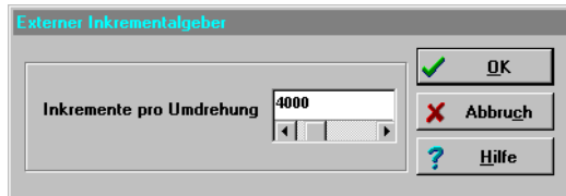
Fig. 8/16: Inkrements per revolution
