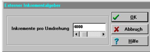
Fig. 8/22: Inkrements per revolution
