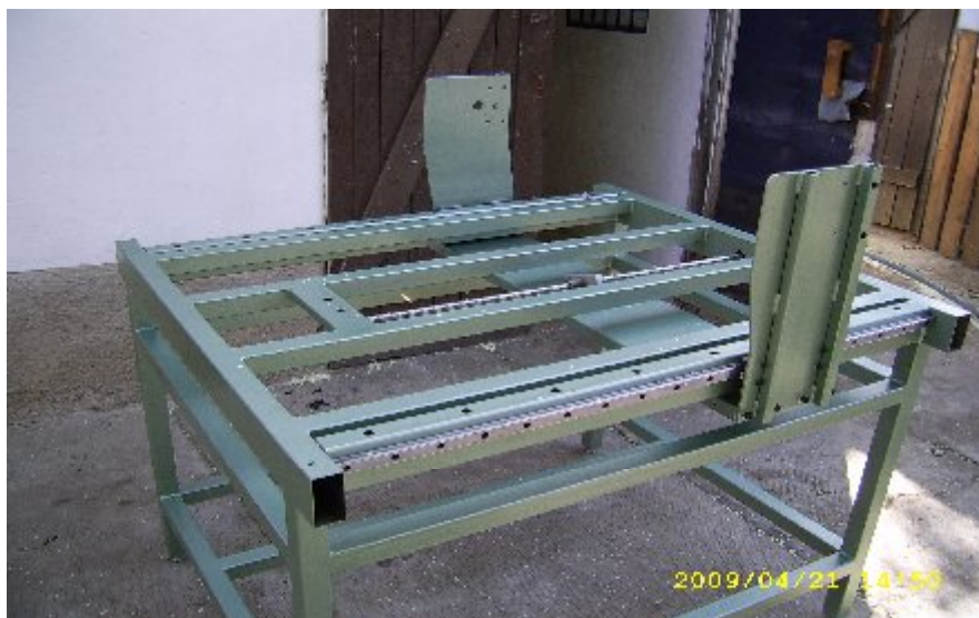
82. ábra A felső gerenda egység végleges szerelése
