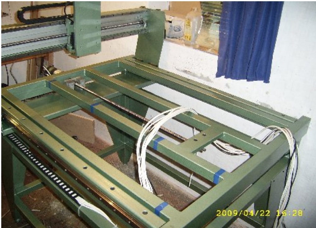
88.ábra Kész van a vezetkezés, már csak a csatlakozások bekötése hiányzik
