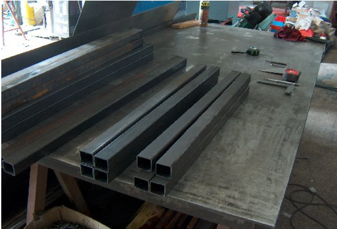
69. ábra A vázszerkezet leszabott alkatrészei
