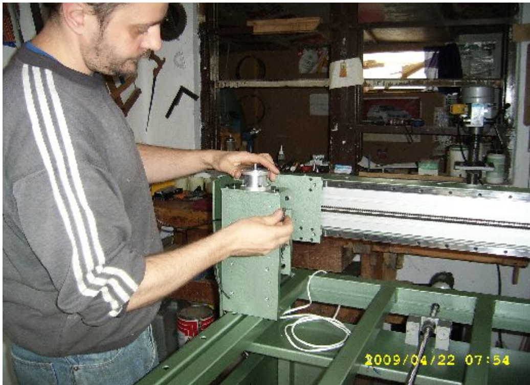
86.ábra A z tengely felszerelése
