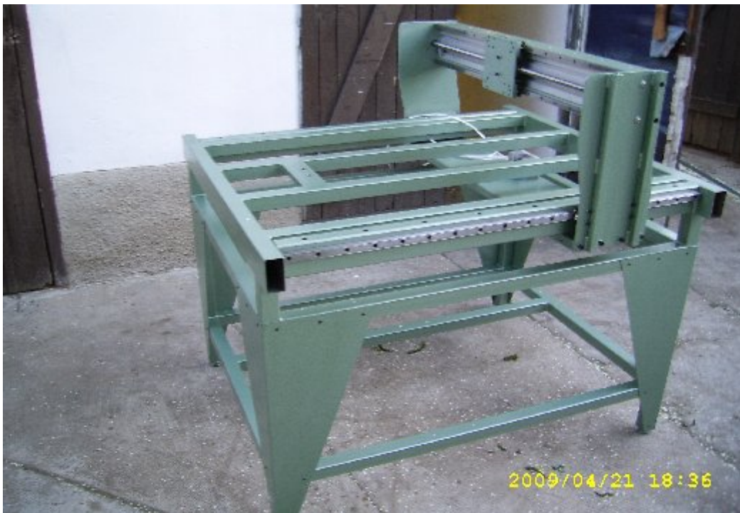
84.ábra A kész gerendázat és a gépváz a sarokelemekkel együtt
