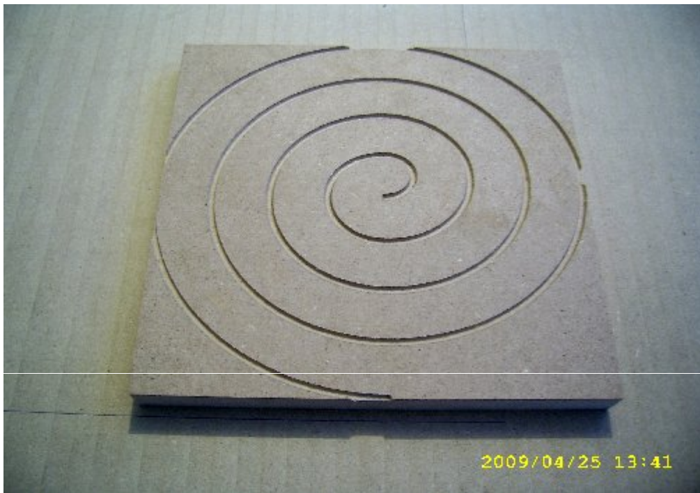
98. ábra A Winmaróval mart csigavonal, nagyon jól lehet tesztelni vele a berendezést
