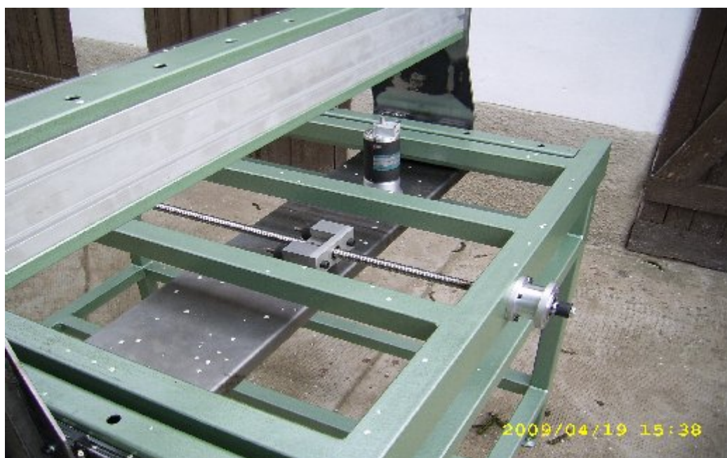
80.ábra Az x tengely próbaszerelése
