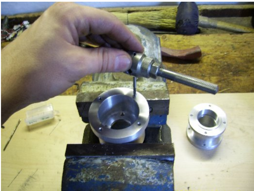
78.ábra A golyósorsó egység csapágháza és motortartója
