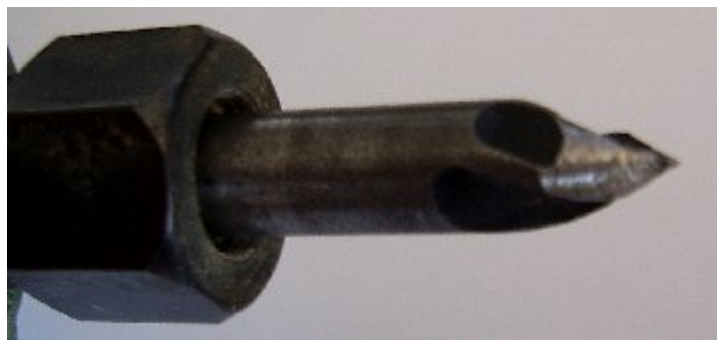
103. ábra A fúróhegyből készített „karctű”
