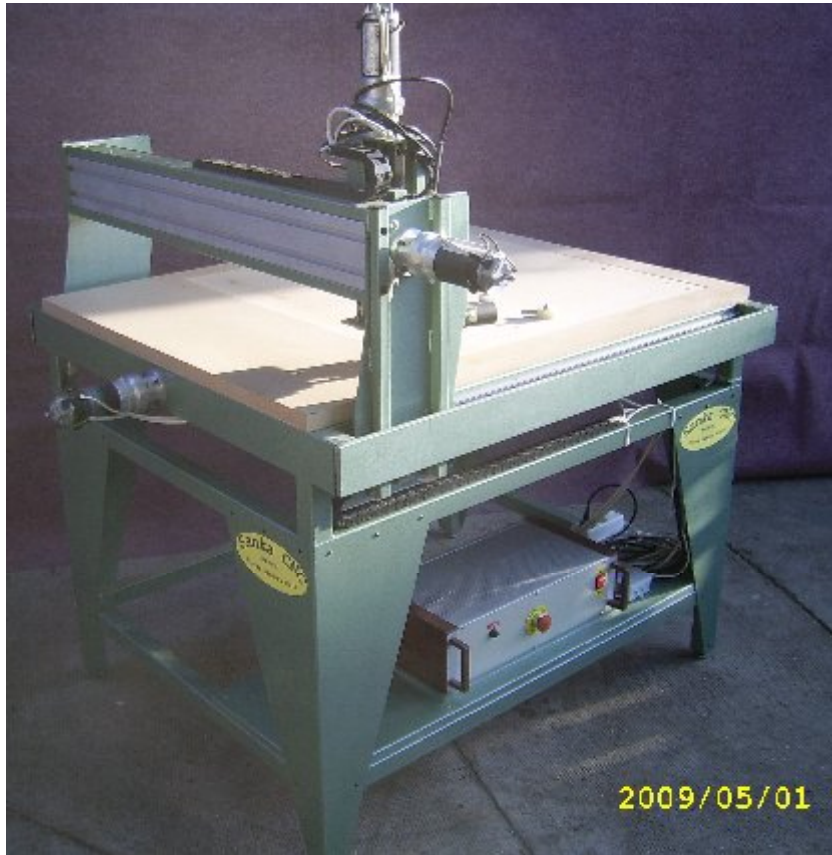
91.ábra A CNC marógépem a vezérlővel és szervomotorokkal
