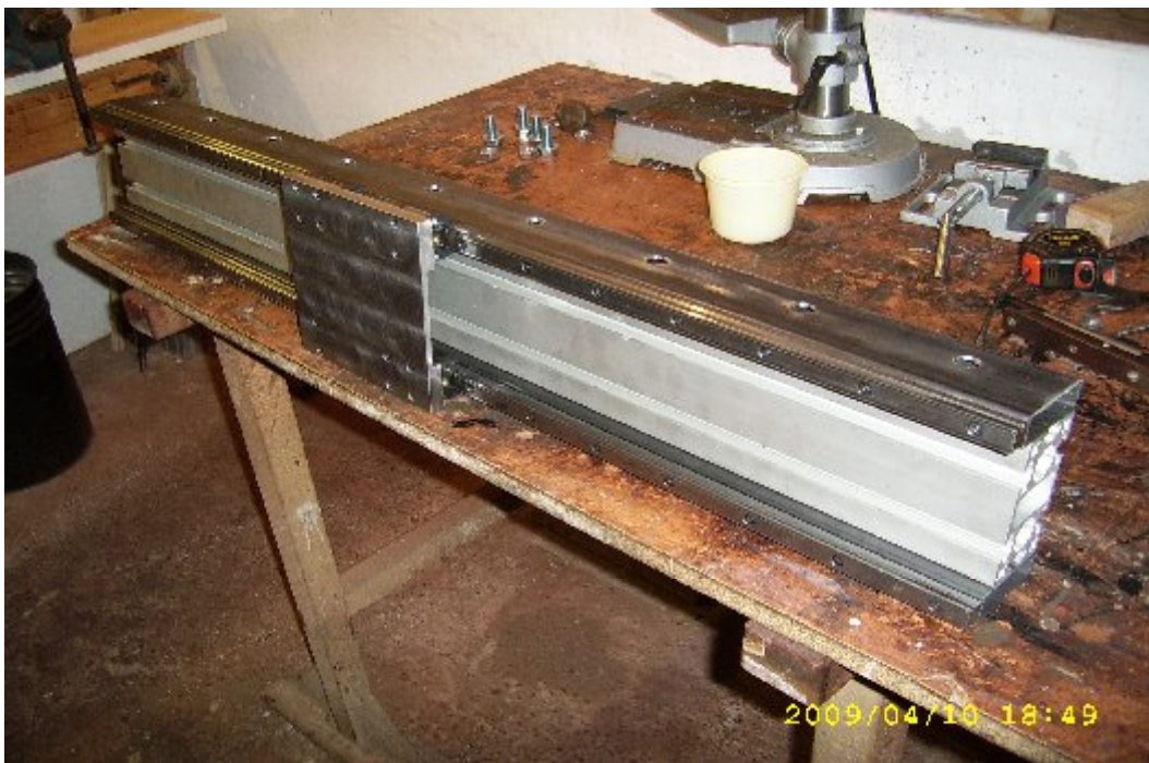
75. ábra Az y tengely próbaállítása
