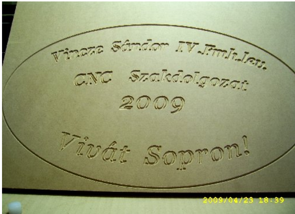
99. ábra Creatorral megrajzolt és a Winmaróval kimart szöveg
