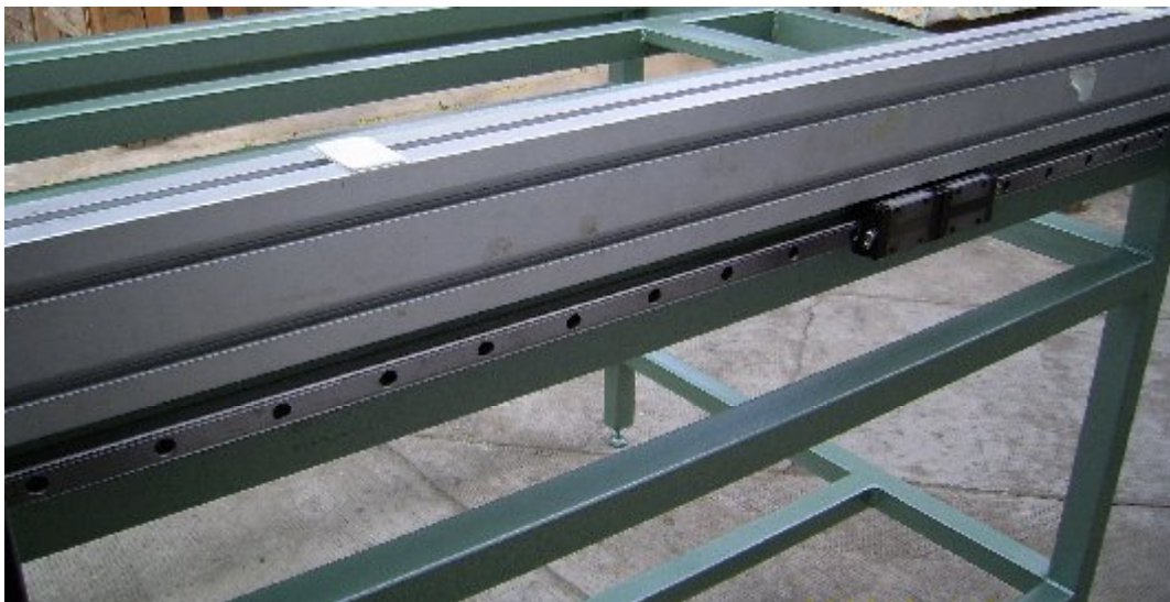
73. ábra Az x tengely felcsavarozása és beállítása
