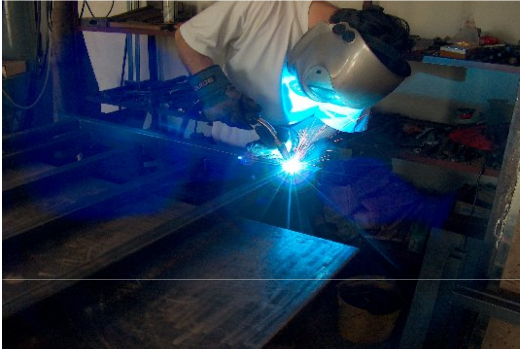
70. ábra A gépváz hegesztése
