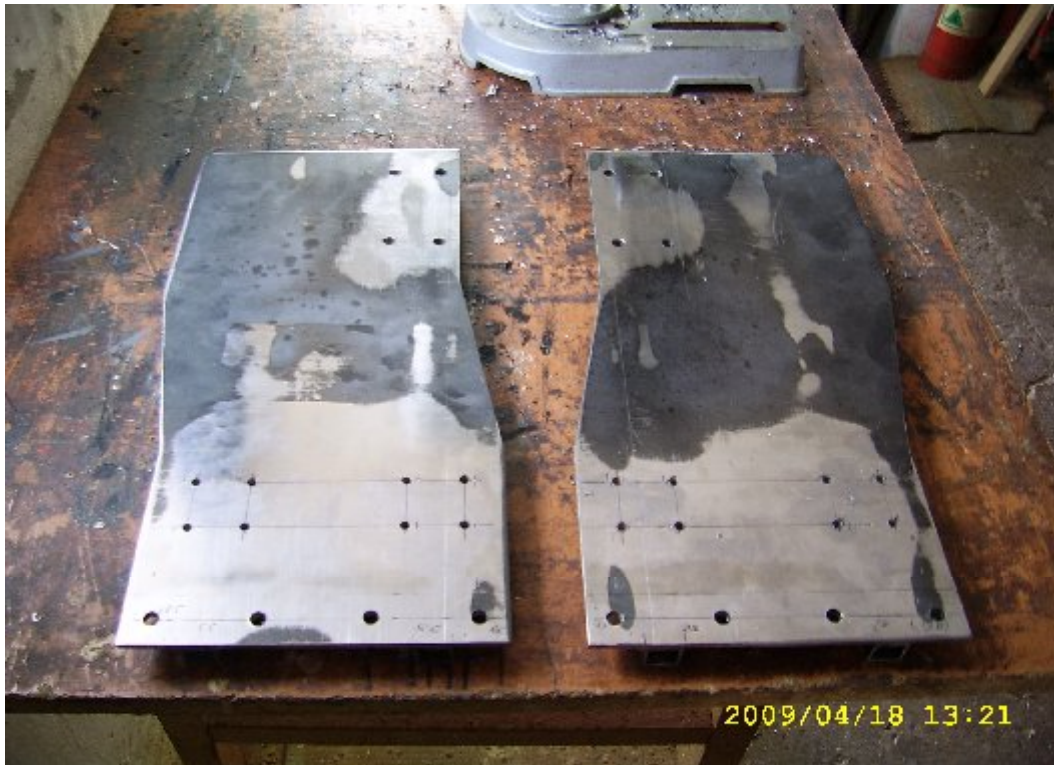
76.ábra A kifűrt oldalsó konzolok
