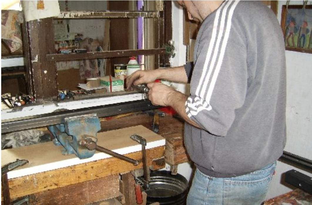
72. ábra Az x tengely lineáris vezeték tartóinak menetfúrása
