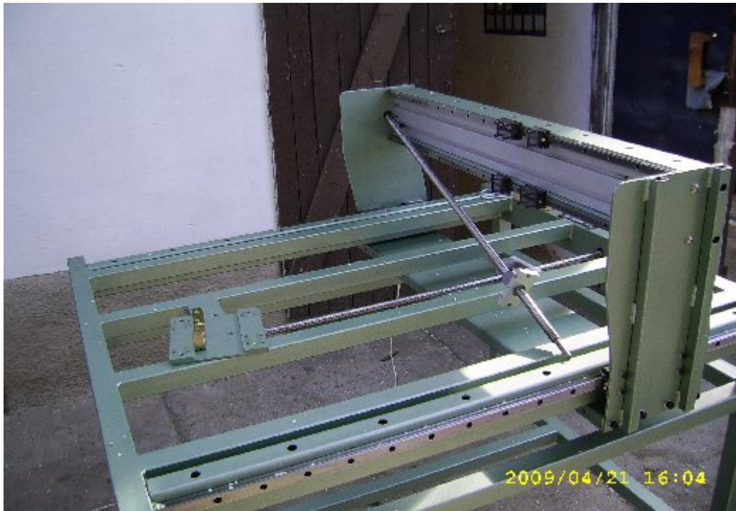
83.ábra Az y tengely golyósorsójának szerelése
