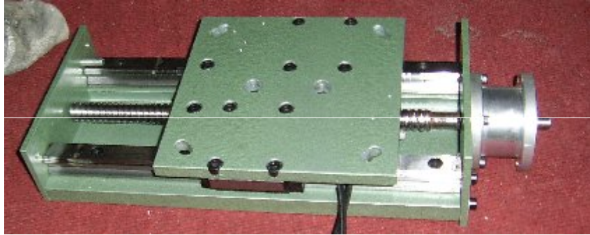
85.ábra Az összeépített z tengely a végállás kapcsoló vezetékével
