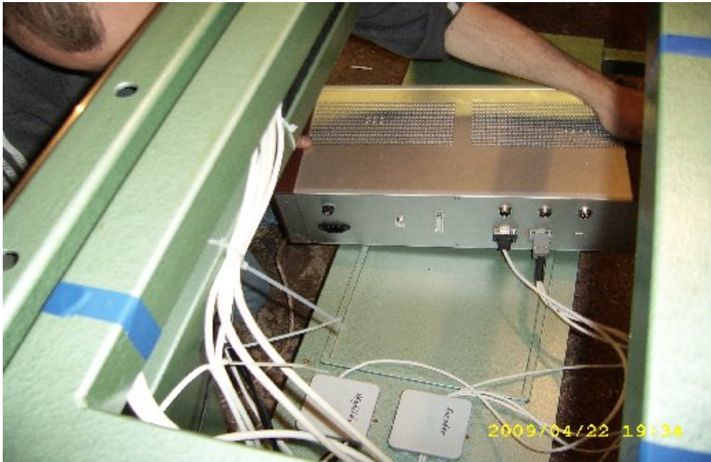
89.ábra A vezérlő és a csatlakozók összekötése
