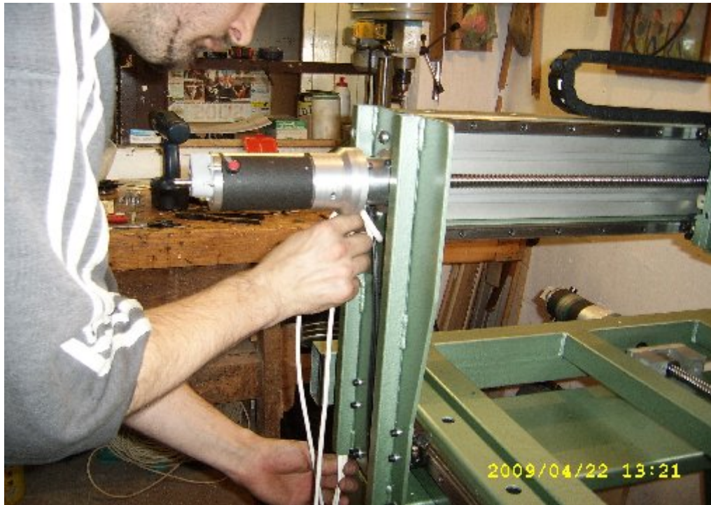
87.ábra Az y tengely elektromos vezetékének „bújtatása”
