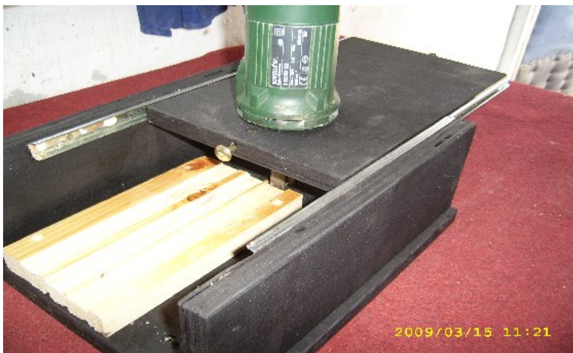
52. ábra Előtolási ellenállás mérése erdei fenyő próbadarabbal
