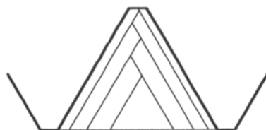
61. ábra Leválasztott forgácsolókeresztmetszetek
