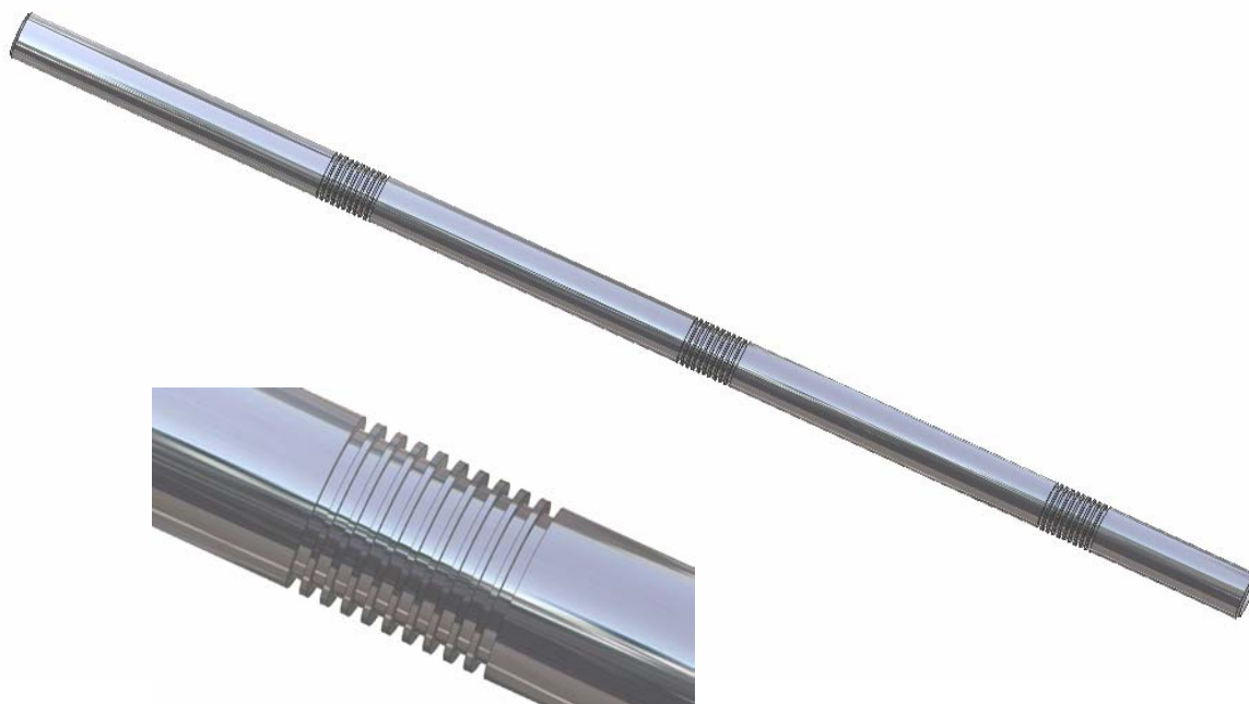
88. ábra Hornyos henger alkatrész 3D takartvonalas rajza
