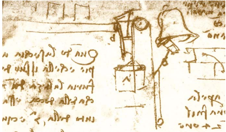
Fig. 4.25. CA, 343 r-a [941 r]. Bell actuation
