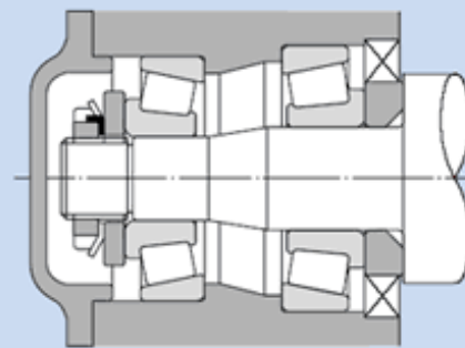
15.9 Ábra Az axiális játék beállítása csapágyanya segítségével
