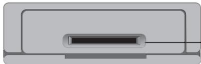
Ein an der Unterseite eingebauter Kartenschacht dient zur Aufnahme von SD- oder MMC-Speicherkarten
