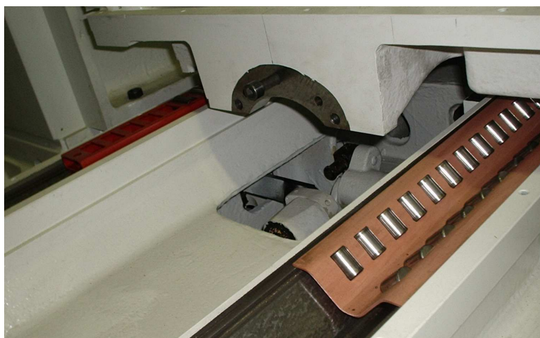
1.3. ábra. Golyós és görgős vezeték szerkezeti kialakítása
