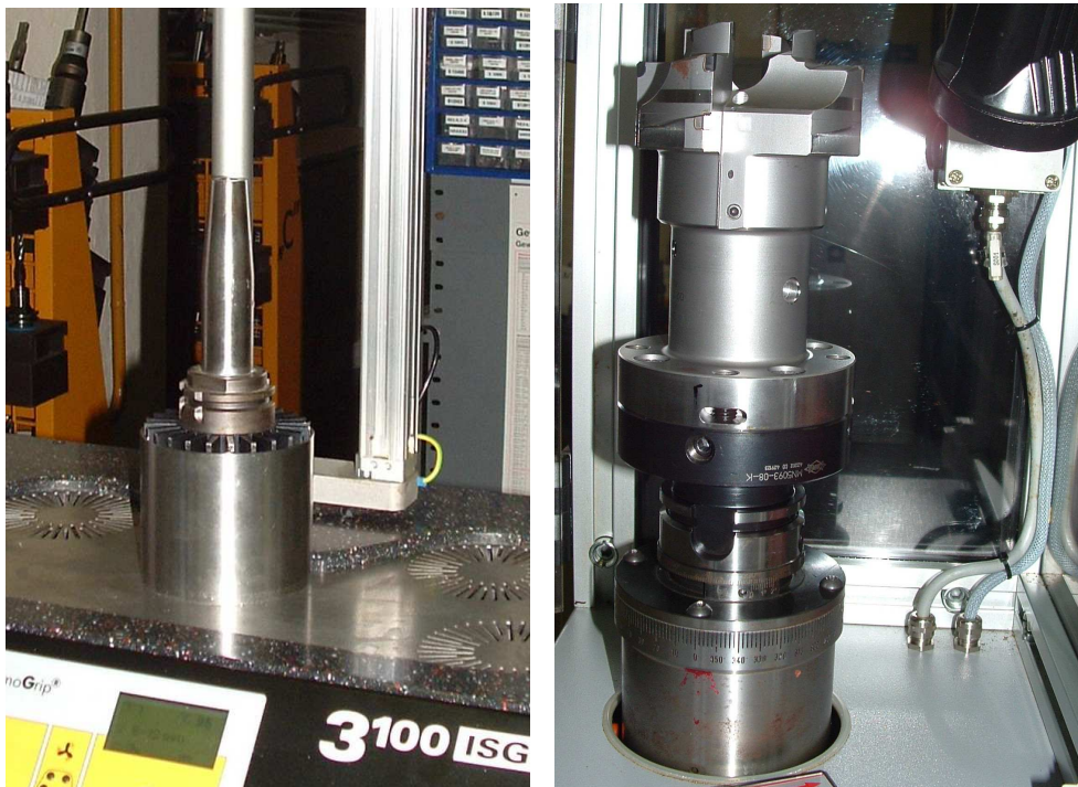
1.42. ábra. Zsugorkötéshez a befogótest felmelegítése, valamint egy szerszám kiegyensúlyozásának folyamata
