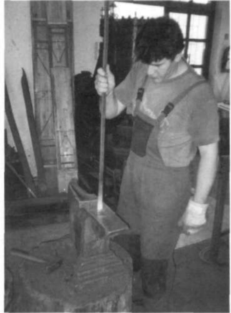
4. 17. ábra. Hosszú kovácsdarab végének duzzasztása üllőn
