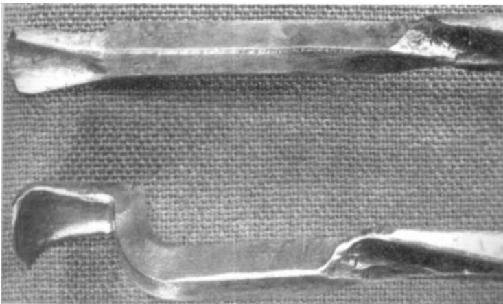
4.77. ábra. Vízszintes rácselem előkovácsolása, függőleges rácselem végének nyújtása, domborítása, 90°-os hajlítása
