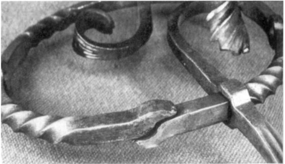
4.79. ábra. Gyűrű hajlítása kör alakra
