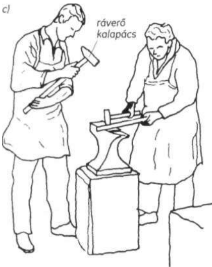
3.77. ábra. Kézi kovácskalapácsok a) ráverőkalapács; b) harántkalapács; c) ráverőkalapács használata
