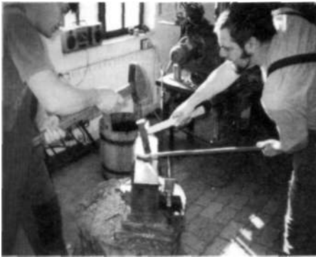
4.43. ábra. A lyukasztás műveletei: a) nyeles vágóval; b) tágítósővel
