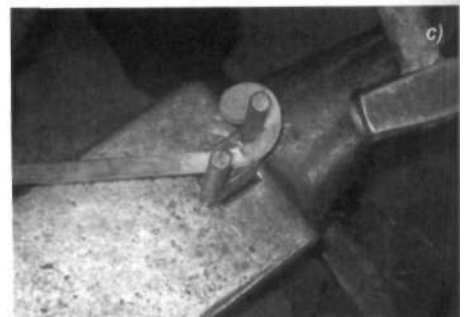
4.28. ábra. Csigavonal hajlítása tűskével .c) a hajlítás munkafázisai
