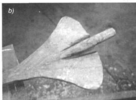
4.10. ábra. Szélesítés a kalapács fokával a) felülnézet; b) oldalnézet; c) keresztkalapács
