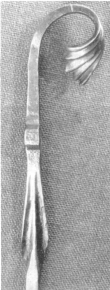
4.76. ábra. Függőleges pálcacselem szárának díszítése lépcsőzéssel
