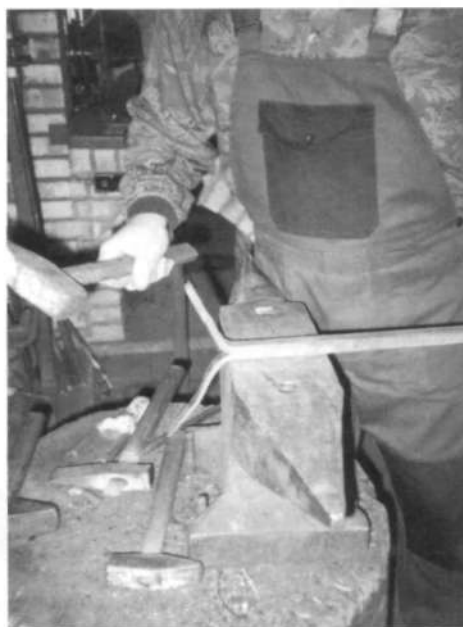
4.39. ábra. A hasítás utáni műveletek munkafázisai
