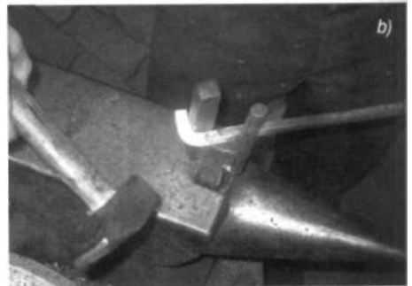
4.25. ábra. Hajlításkor fellépő feszültségek és alakváltozások
