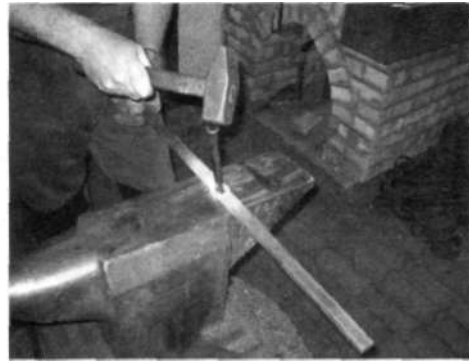
4.43. ábra. A lyukasztás műveletei: a) nyeles vágóval; b) tágítósővel
