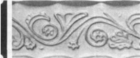
2.6. ábra. Felületi díszítéssel ellátott hengerelt szelvények
