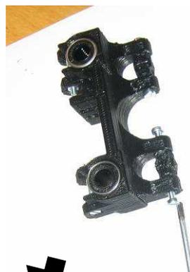
Schraube festziehen. Kreuzgelenk muss **leichtgängig** sein. Falls nicht die Seiten des Kreuzgelenk mit einer Feile nachbearbeiten
