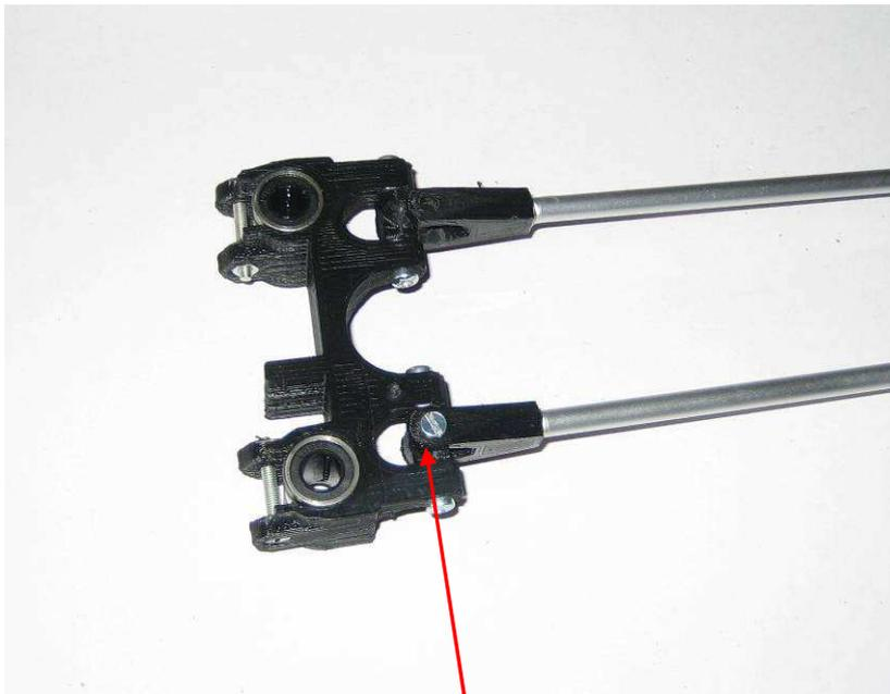
Gelenkseite des Schlitten ist oben, Schraube nur leicht anziehen, Die Stangen sollen leicht beweglich sein
