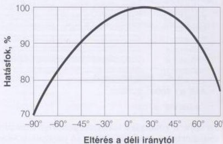
22 ábra. A napkollektor hatásossága a dőlésszög és a tájolás függvényében
