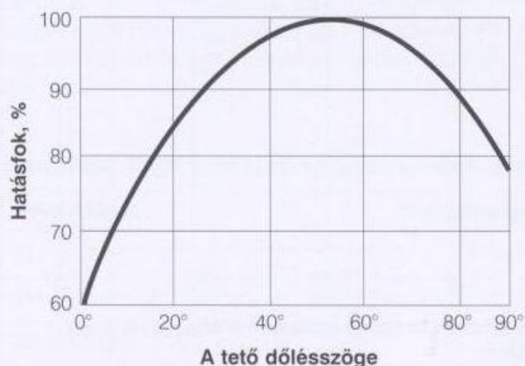
22 ábra. A napkollektor hatásossága a dőlésszög és a tájolás függvényében
