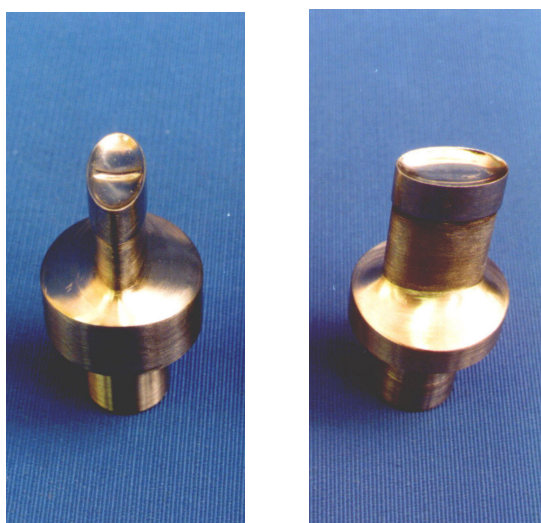
94. ábra Amoxicillin 750 mg laboratóriumi tablettázó bélyegek (BIOGÁL Rt. 1995)
