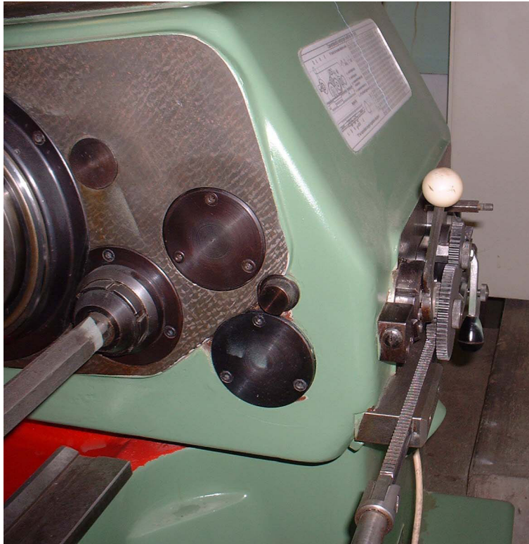
6. ábra A differenciálmű behajtás (fogasléc és fogaskerekes hajtómű)
