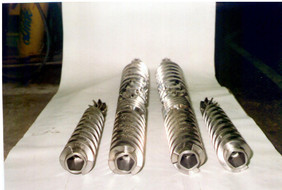
80. ábra Szerelésre előkészített csigaelemek
