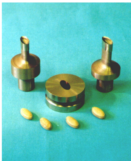
93. ábra Augmentin 375 mg laboratóriumi tablettázó szerszám (BIOGÁL Rt. 1995)
