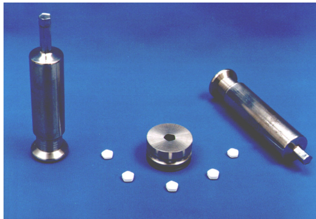
97. ábra Tablettázó szerszámkészlet HHE5 (GÉNIUS'96 Találmányok és Újdonságok Nemzetközi Kiállítása, Budapest)
