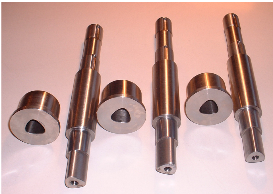
83. ábra Szerelésre előkészített keverő lapát tengelyek és agyak
