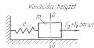
20.14. ábra. Gerjesztett, csillapítatlan lengőrendszer modellje
