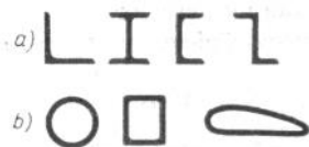
10.4. ábra. Vékonyfalú rudak a) nyílt szelvényű; b) zárt szelvényű
