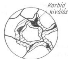
16.5. ábra. Mikroszkópi felvétel kristályszerkezeti korrózióról
