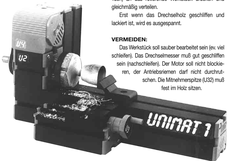
Querholzdreheln mit der Planscheibe (Holz: Birnenast)
