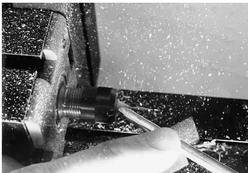
Tournage des miniatures sans poupée mobile avec 6000 tours/minute (bois : hêtre, 6mm).
