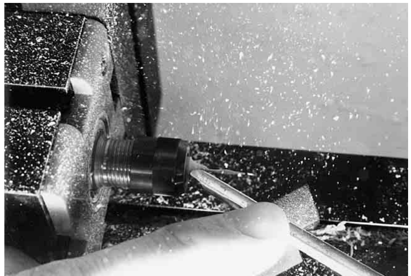
Fliegend drechseln mit 6000 U/min (Holz: Buche 6 mm)
